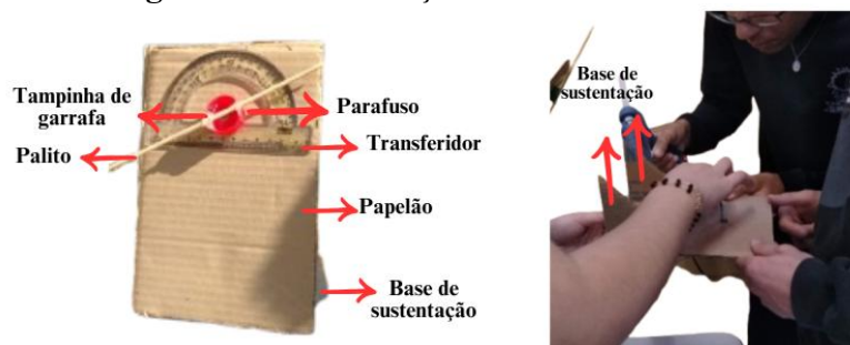
Figura 2 – A construção do teodolito caseiro
